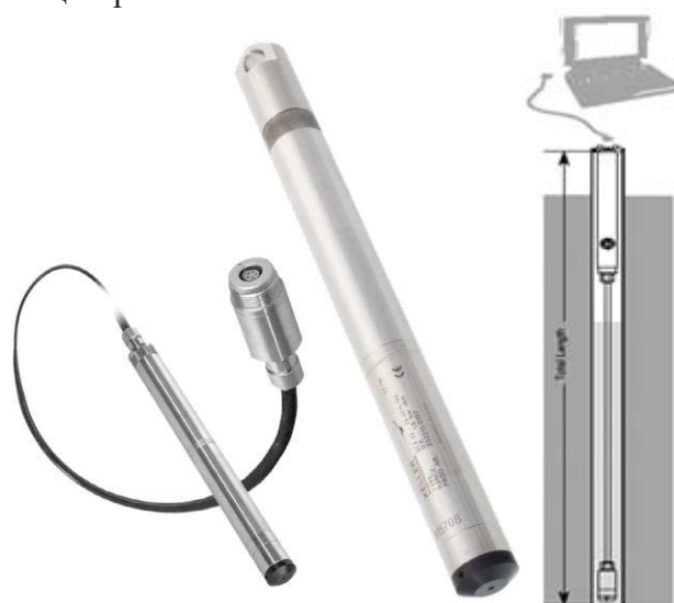
Рис. 1. Електронний рівнемір DCX-22
